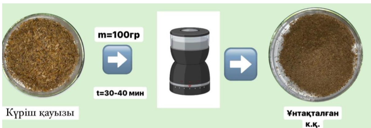
7 сурет - Күріш қауызын ұнтақтау процесі
