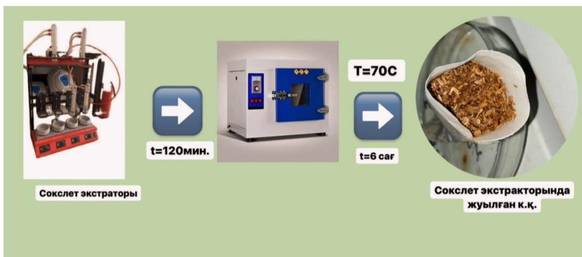
8 сурет - Сокслет экстракторында к.қ. гексанмен жуу процесі
